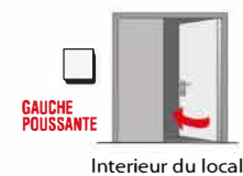
GAUCHE POUSSANTE Intérieur du local
