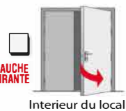
GAUCHE TIRANTE Intérieur du local
