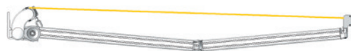
Bras de tension à câbles, à angle de 8° pour dégager la toile des bras
